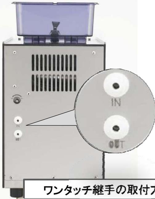
スノーパウダーマシンを設置する際にはマシン背面にある【IN】から【水道との分岐口※注1】へ【OUT】から【排水】へ専用チューブでつながります。
